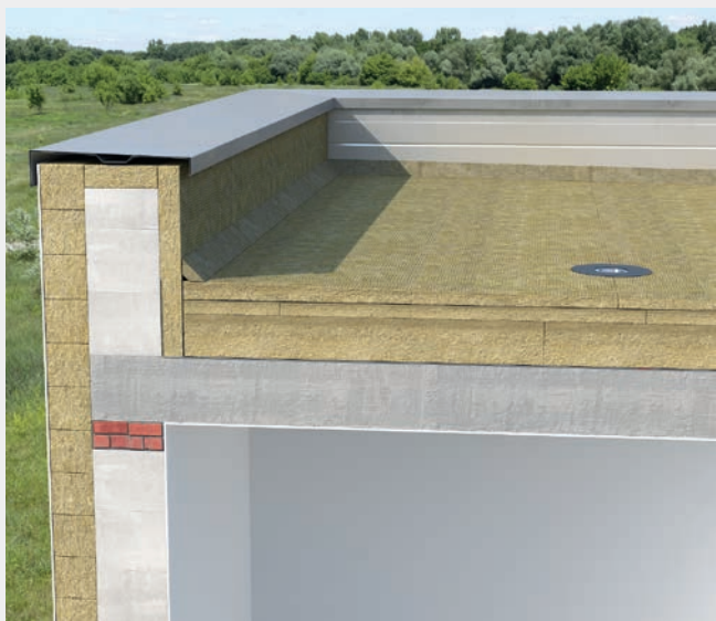
Ukształtowanie spadków płytami ROCKFALL (SP).
