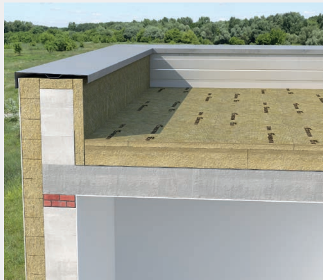
Układanie płyt zasadniczego ocieplenia na sucho.
