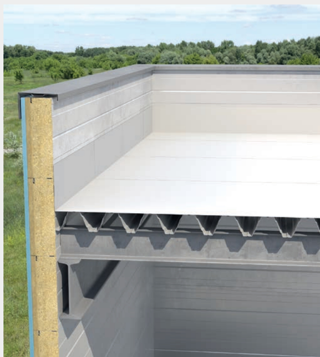
Układanie folii paroizolacyjnej PE na blasze trapezowej.
