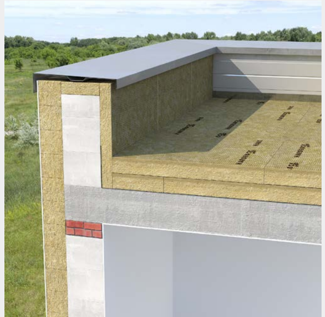
Układanie płyt HARDROCK MAX w dwóch warstwach.
